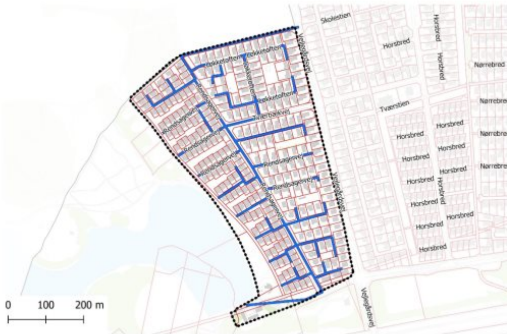
Figur 1: Fjernvarmeområde og ledningsnet - Rendsagervej og Løkketofte
