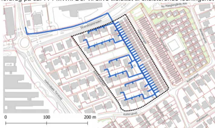
Figur 1: Fjernvarmeområde og ledningsnet - Grundejerforeningen Kollerupparken
